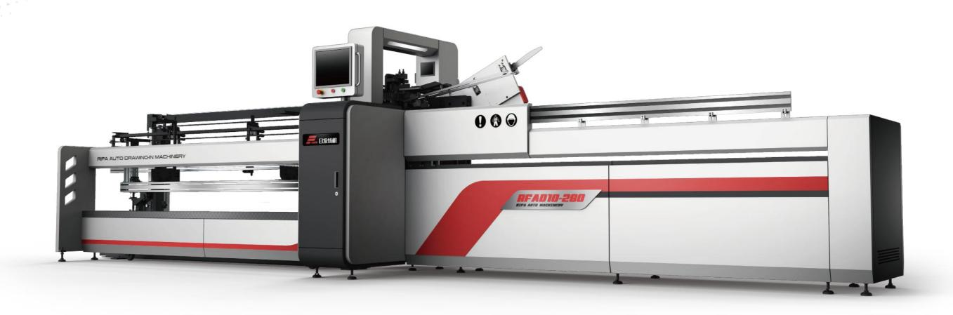
RFAD10全自动穿经机是一款基于种纱模式的穿经设备,穿经与织轴没有关联,可提前预穿,与前准备工序并行,市场响应快。穿经作业完成后可储备、可代工、运输方便。整机能耗低。瞬时功率小于1KW,气耗0.3m³/min,使用费用极低。其主要优点如下:
