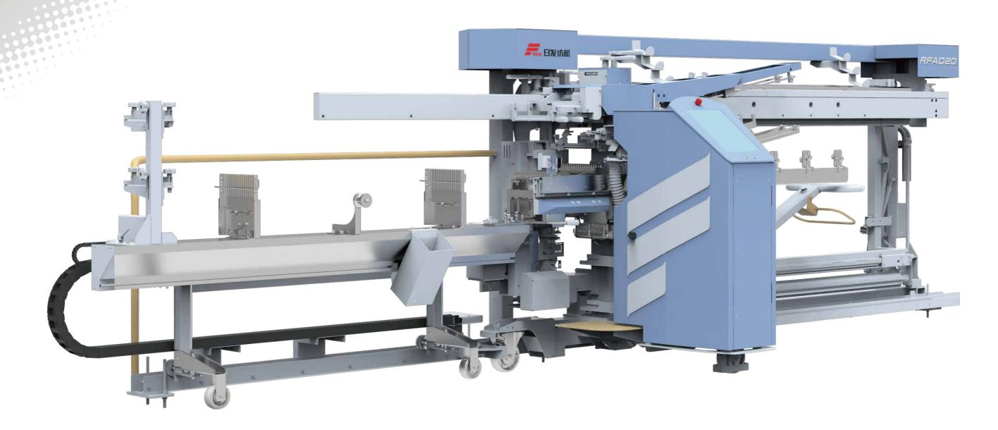
RFAD20全自动穿经机是针对化纤长丝纱的穿经需求开发的一款设备,可适用于西装衬里、休闲服装、遮阳蓬布以及产业用布等面料的穿经作业。该机型由一台移动式穿经机和1个或多个固定式穿经站组成,可完全自动将经纱穿入综丝和钢筘,综丝可排出到最多16根综条上。该机型具有非常高的穿经能力,设计最高速度260根/分钟。同时该机型还具有空间布局的灵活性,能最大程度的提高织造车间利用率,方便转运与储存。
