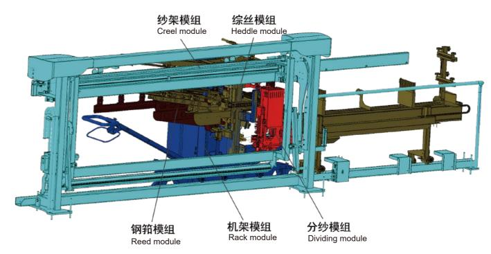
从机械结构上RFAD20自动穿经机可分为5个部分:分纱模组、钢筘模组、综丝模组、机架模组和纱架模组。各个部件在设备上位置如上图所示。
