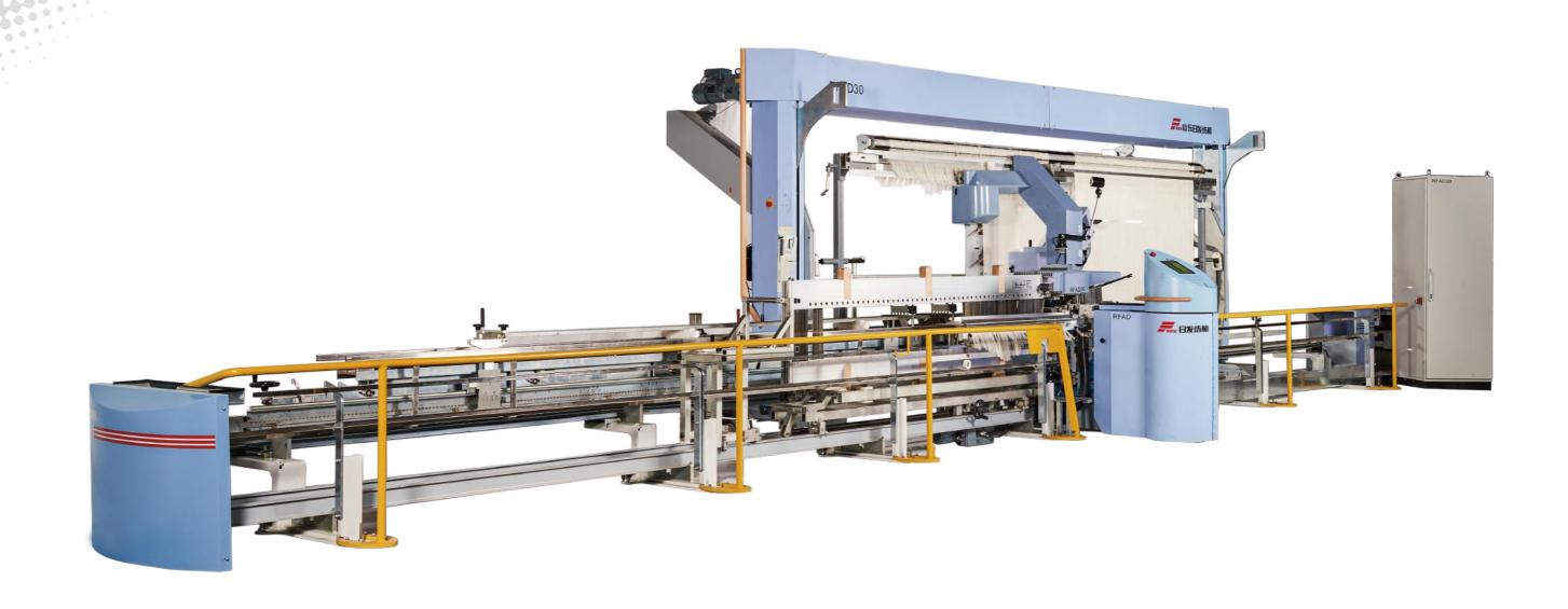
RFAD30全自动穿经机是一款应对复杂工艺面料穿经的一款设备。该机型功能完备,标准配置具有升级功能的纱架车、具有拆分绞功能的机头,功能可选色循环监视。还可针对粗支纱、毛纺纱、扁丝等进行特殊配置。搭配我们已开发完成的色织分绞机,可完全适应色织等高复杂组织的穿经作业。
