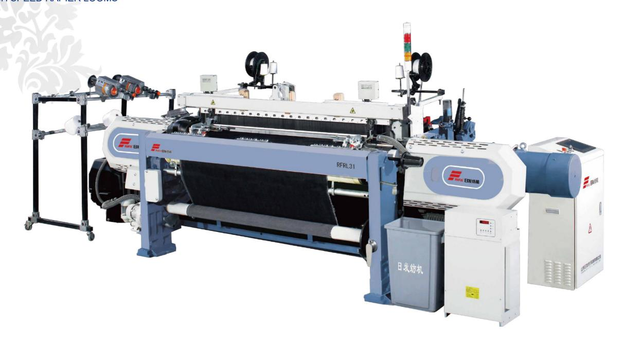
我司一直致力于纺织技术增值的研究,使客户更经济的生产出更好的产品。RFRL31节能高速剑杆织机的成功开发便立足于此。 高效的织造、强劲的打纬力、良好的高速稳定性、先进的电气控制系统、便捷的操作性是织机的独有特色,RFRL31秉承RFRL30织机的卓越性能,采用超启动马达直接驱动,由先进的SRD电子调速系统控制, 织物品质好,功率因数高,能耗低,是一款达到国际先进技术水平的高效节能型高档剑杆织机。
