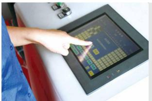
数字化自动控制: 应用多核心多总线控制技术,全面实现数字化控 制。高性能CPU微处理器管理和监控所有电控单元,实现多种自动 化功能: 织口自动补偿、自动寻找织口、张力自动调整、自动控制织边 绞边时间、储纬器自动切换、空打纬、网络监控、故障自诊断等。 操作维护快捷方便: 人性化友好操作界面,USB接口,可即时设定 调整各种工艺参数,进行工艺编程。
