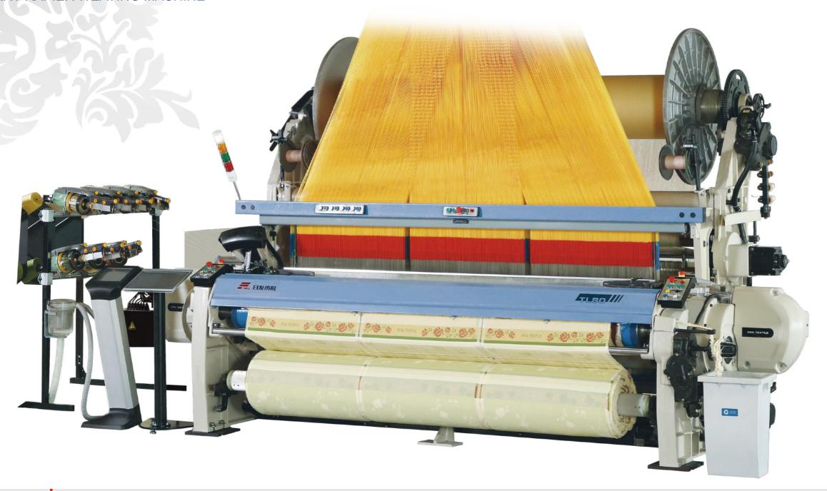
全新积极式毛经后梁罗拉,全新毛经形成单元 和全新地经后梁罗拉。以上三个创新装置的设 计,使得这款织机的质量得以巨大提升。
