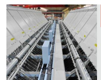
安装上下两排吸油烟管,在生产过程中,能将纱线通过热箱后 所产生的油烟有效吸除,确保车间环境及设备的清洁。
